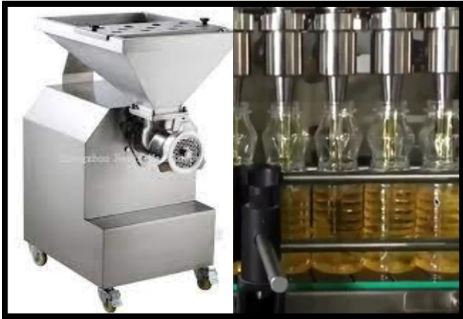
Mesin pengisar dan mesin pengisi cecair mempercepat pemrosesan dan pengeluaran makanan
